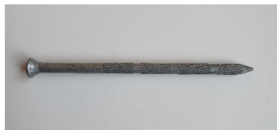
6. Verzinkte regelnagel, gebruikt als meet-elektrode
