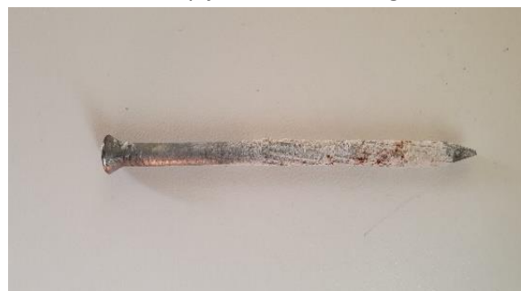
10 . Verzinkte regelnagels als spijkerelektrodes; conditie van een spijker na ca 2 jaar in de kelder muur
